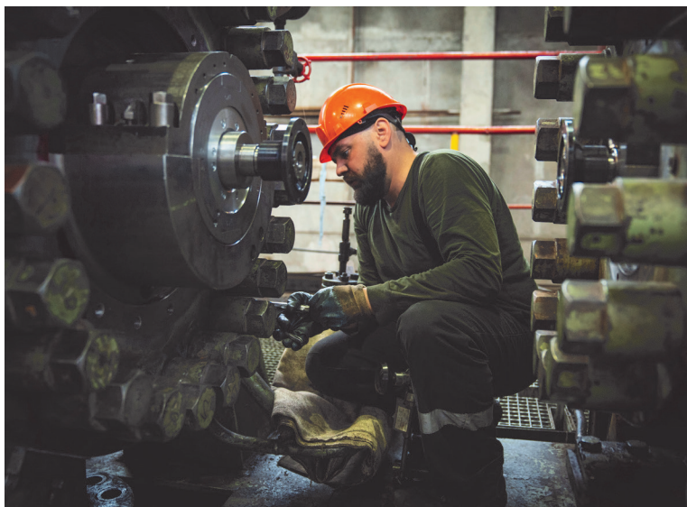
▲ Компрессор углекислого газа цеха карбамида диагностируется с особой тщательностью
