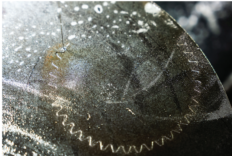
▲ Молибденовая проволока легко вырезает деталь по заданным параметрам
