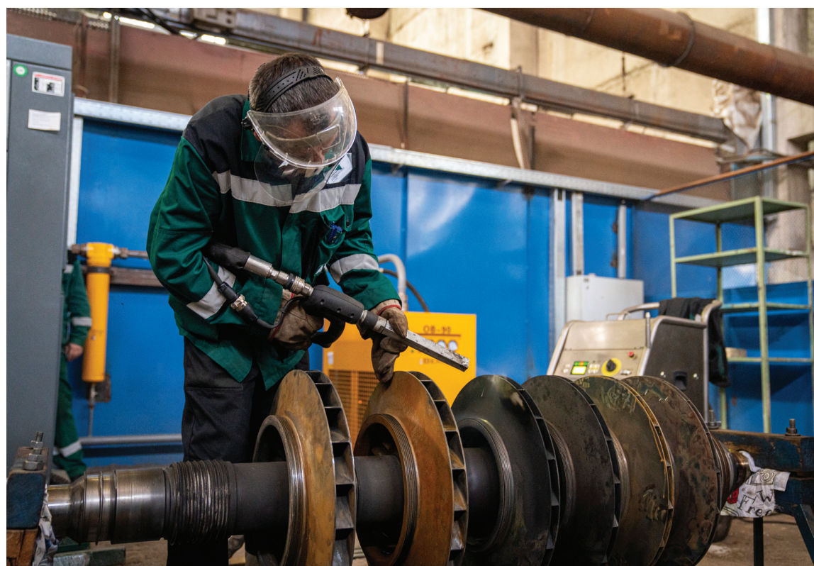
▲ Обработка ротора при помощи установки криогенной очистки
