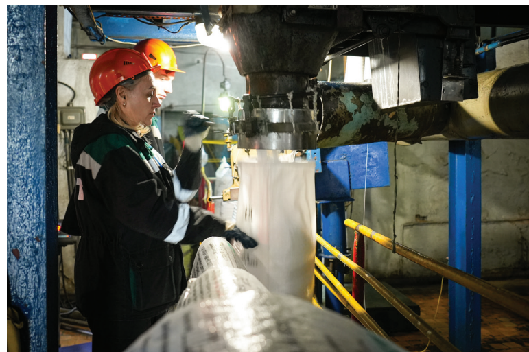
▲ На участке азотной кислоты, углеаммонийных солей и аммиака водного технического может производиться до 2000 тонн гидрокарбоната аммония в месяц
