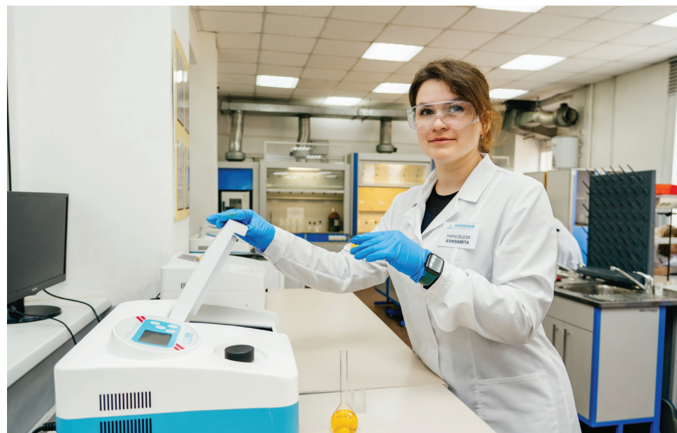
▲ Участницам необходимо было определить диоксид серы йодометрическим методом
