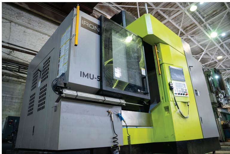
▲ Так выглядит пятикоординатный обрабатывающий фрезерный центр с числовым программным управлением
