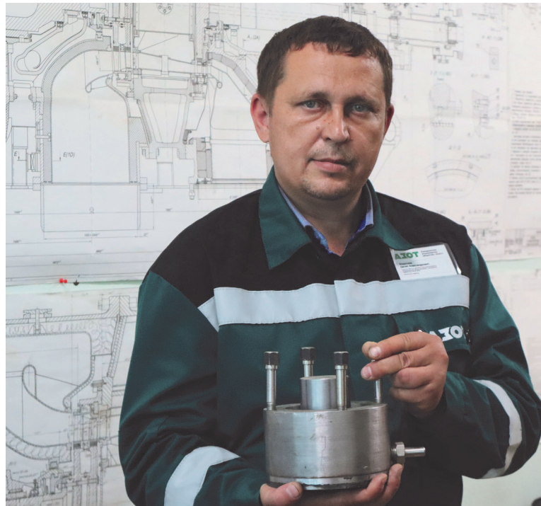
▲ Денис Федосеев и его изобретение – приспособление для опрессовки сальниковых камер
