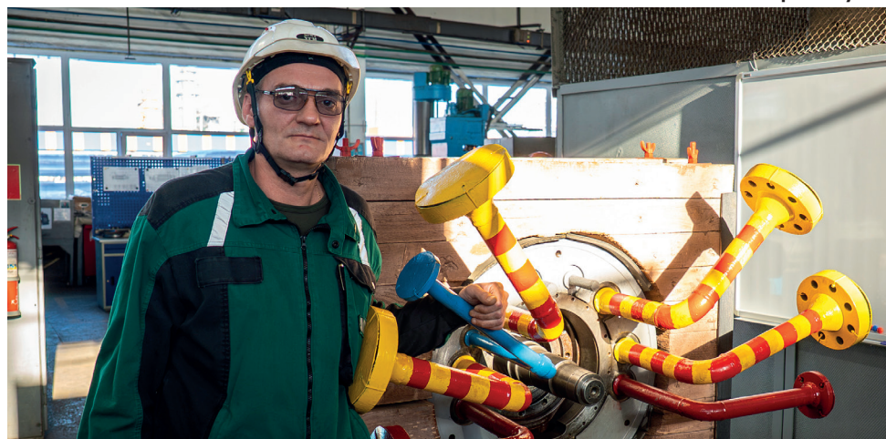
▲ Алексей Никишин и его реализованная идея – тренировочный стенд для ремонта компрессора позиции 401
