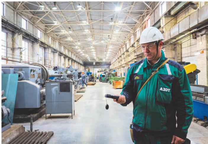
▲ Измерение уровня освещённости цеха после модернизации и замены освещения
