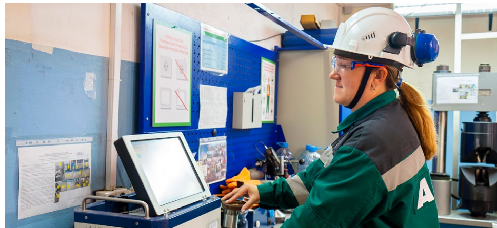
▲ Оптико-эмиссионный анализатор PMI Master позволяет определять химический состав металлов
