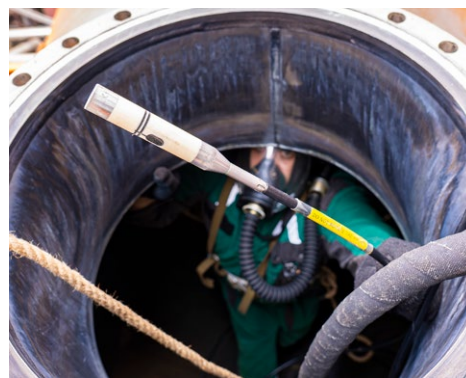
▲ Вихретоковый дефектоскоп «Эктан» помогает выполнять диагностику трубных пучков теплообменных аппаратов
